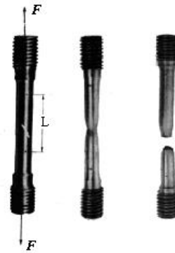
Muestra típica de sección circular para el ensayo de tensión - deformación
