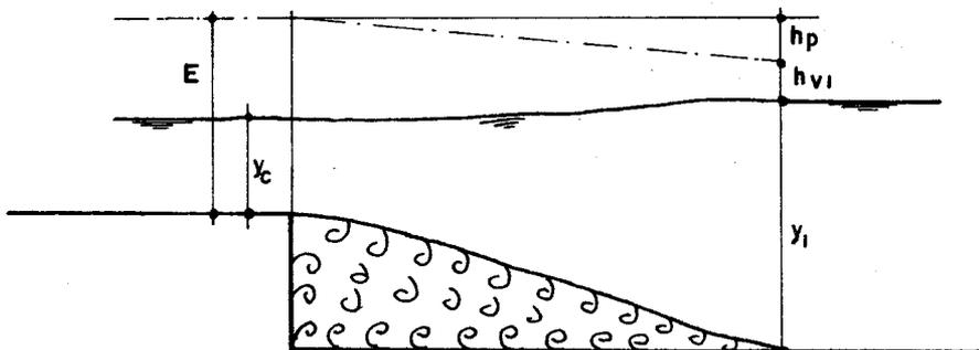
La sección sobre la grada es la sección de partición y la sección (1) se toma en el canal derivado que decide el cálculo.
