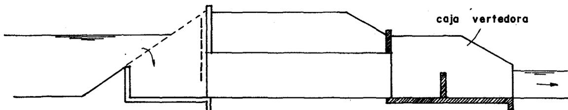
Medidor de flujo abierto.- Es un dispositivo que tiene básicamente una rueda calibrada y que por lo general se instala a la salida de una toma de tubería, en vez de la caja vertedora.
