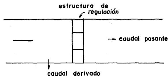
Represa.- Se construye transversalmente al canal y consta de dos partes; una parte siempre fija constituida por los muros a los costados y una parte:
