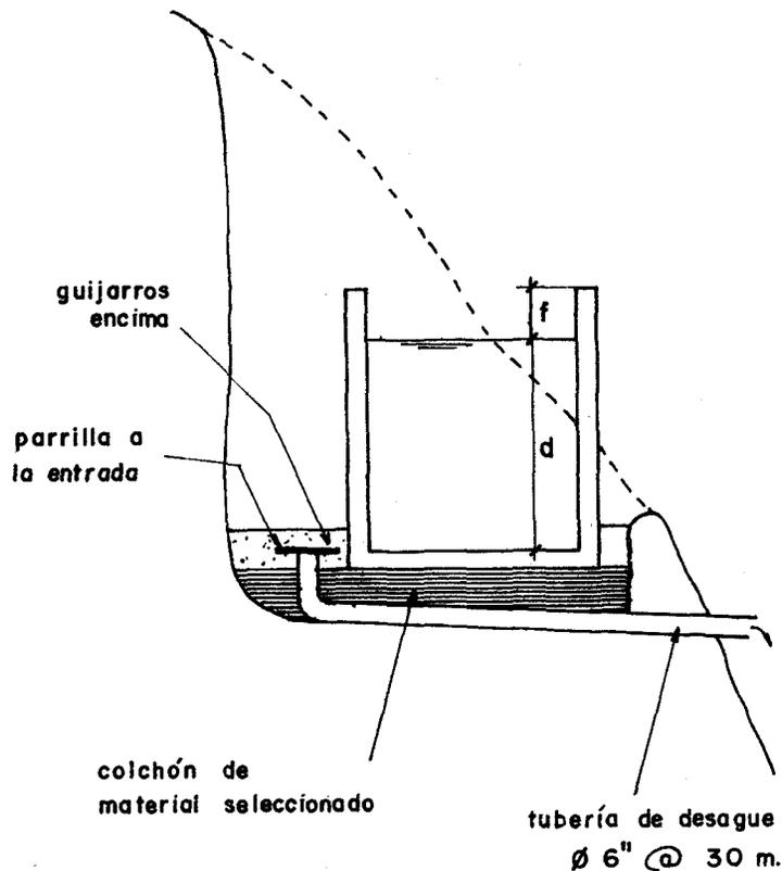
Relación b/d.- A la sección rectangular más eficiente corresponde un valor 2. Por razones constructivas se usan valores por lo general comprendidos entre 1 y 3. Para este rango de valores de la relación b/d los valores de A, V y P varían muy poco para el rango usual de valores  $S_0$  y caudales pequeños.
