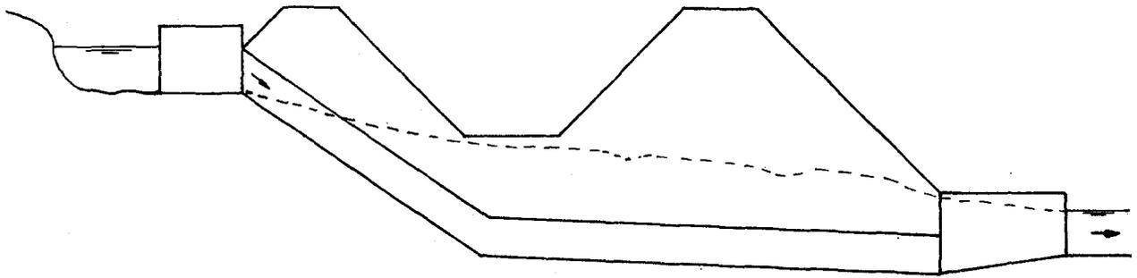
Paso superior.- Se usa cuando el nivel del agua en el canal es bajo en relación al nivel del agua de lluvia por eliminar. El paso superior puede consistir de un flume elevado o de una canoa.
