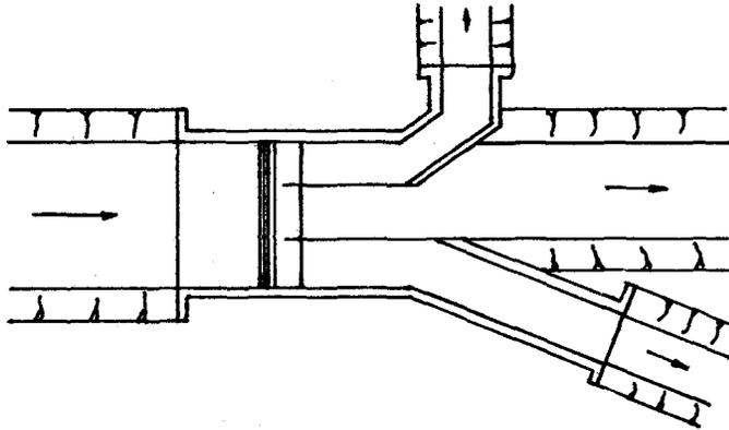
Represa a la entrada de tubería.- Se usa para derivar una parte del agua del canal antes que ésta ingrese a una estructura de conducción de tubería (cruce de vía, sifón invertido, caída entubada, chute entubado). Se emplean compuertas deslizantes, agujas y vertederos graduables como elemento de regulación.
