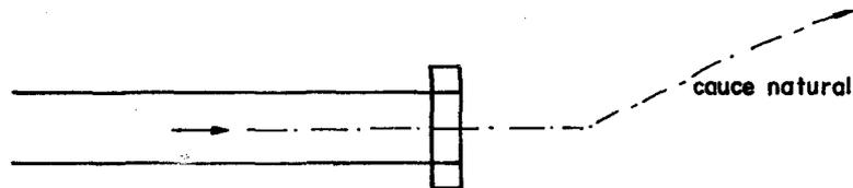
NOTA. Obsérvese cómo una estructura terminal de tubería con represa a la entrada cumple el doble cometido: evacuación del exceso de agua en el canal por encima de los muros de rebose y vaciado del canal levantando la compuerta deslizante o las agujas. De la misma manera se puede usar una estructura terminal tipo caída rectangular inclinada con represa a la entrada.
