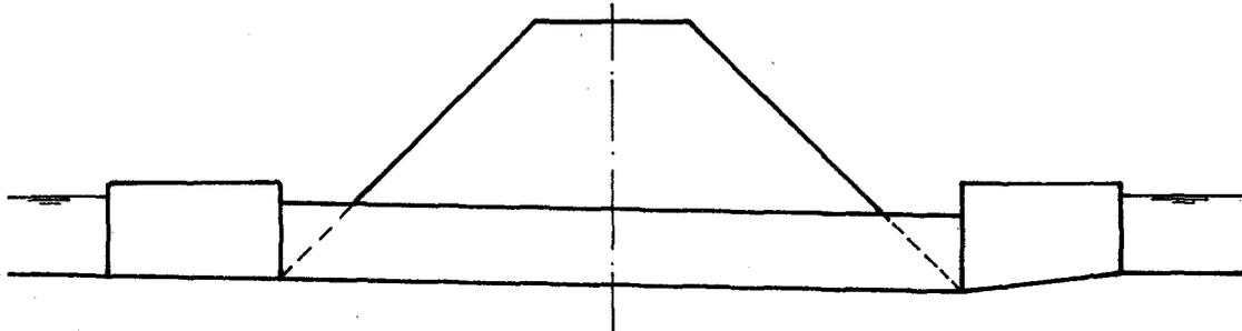
La alternativa a cruce de vía es un puente construido en la vía de carretera o ferrocarril. Para caudales moderados se usa siempre cruce de vía.
