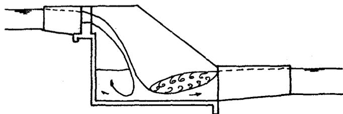
Toma.- Se ubica en la pared del canal con el fin de derivar una parte del agua.
