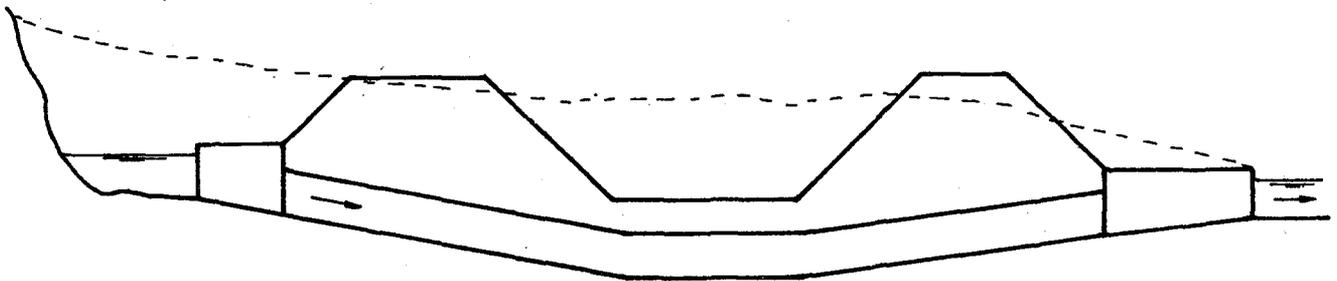
Alcantarilla.- Se usa muy eventualmente, cuando la sección del canal queda en relleno.
