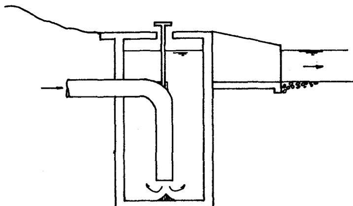
Estructuras de disipación de tipo salto hidráulico.- El agua afluyente, a gran velocidad, es forzada a un salto hidráulico. De ese modo se produce la disipación.
