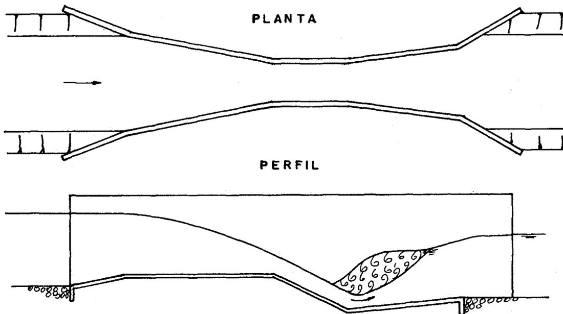
Flume Parshall modificado.- Es un flume Parshall en el que la sección de salida se adecúa a un perfil particular del canal, generalmente un chute corto.
