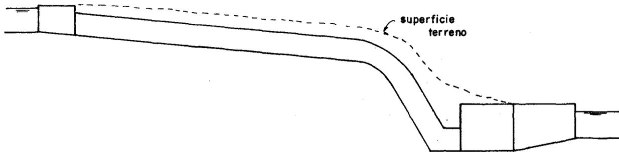
La alternativa a chute abierto consiste en emplear una serie de caídas verticales. El chute tiene un costo inicial elevado y un costo de mantenimiento bajo; en el juego de caídas verticales es al revés. Por lo general se prefiere el chute.
