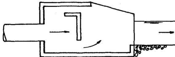
Pozo disipador con válvula de manga
