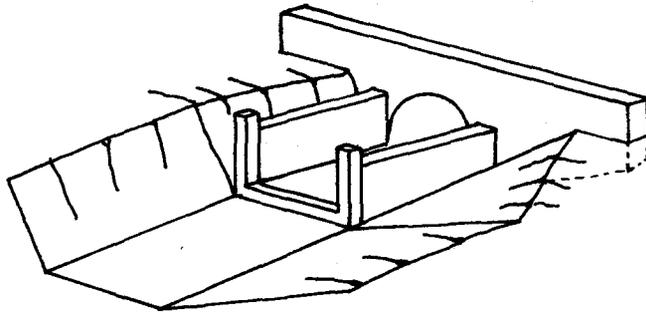
Escotadura de control a la entrada de tubería.- Se usa de manera similar a la estructura anterior pero sobre todo antes de caída entubada y chute entubado, es decir tuberías de fuerte inclinación. En vez de escotaduras se emplean a veces vertederos. Las escotaduras trapezoidales y los vertederos son elementos de control hidráulico que sobre todo impiden el embalamiento del agua.
