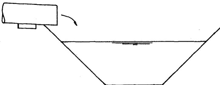
NOTA. El agua de lluvia arrastra sedimentos provenientes de la erosión del terreno, por lo que en el diseño de las estructuras de protección exterior es necesario tener en cuenta la presencia de estos sedimentos.
