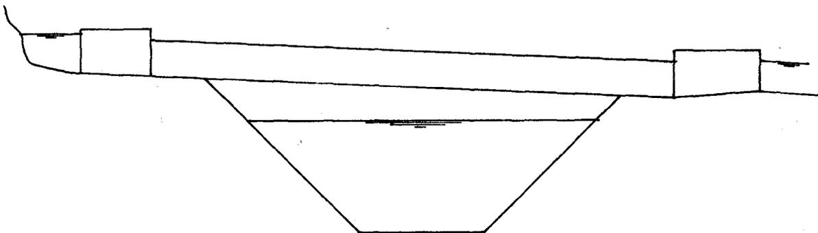
El flume elevado puede ser de concreto o de tubería. La canoa es siempre de concreto.
