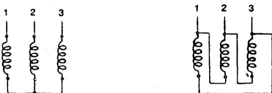
**Fig. 8.20** (c) Conexiones estrella y triángulo para las tensiones mayor y menor respectivamente.
