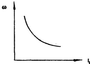
Fig. 5.27 Curva de velocidad  $\omega - I_p$  para un motor shunt.
