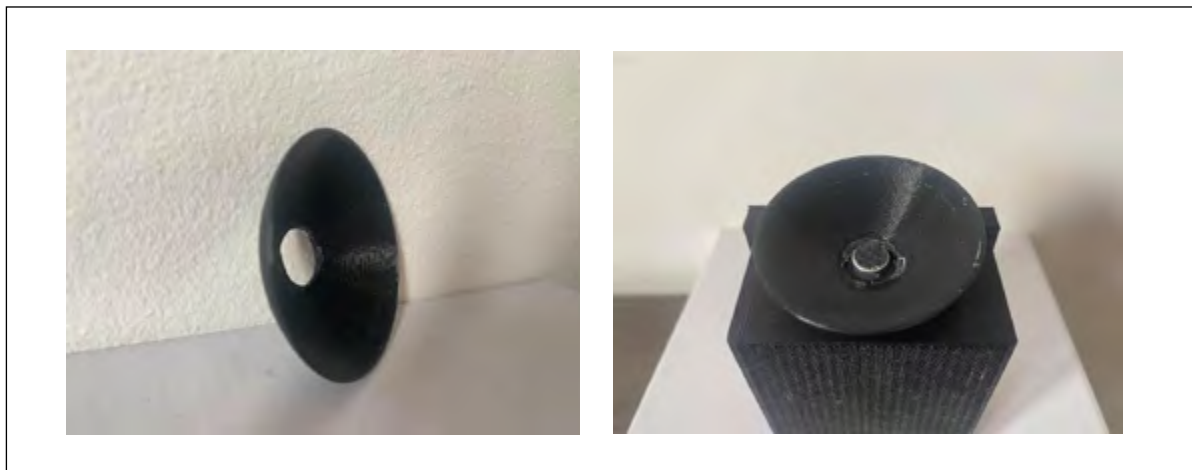
FIGURA 2. Impresión 3D del paraboloide diseñado para la captación de señales de ruido acústico
