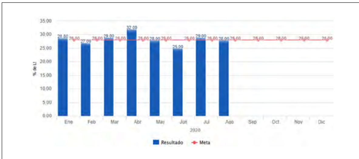
FIGURA 5. Producción de lixiviado (L) por tonelada de residuos ingresadas al PTA en los ocho primeros meses de 2020
