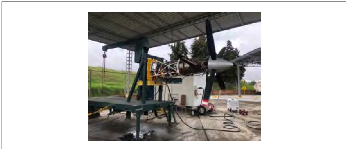
FIGURA 5. Banco de Prueba adaptado para Motor PT6A-61 a . Se visualiza el motor montado en el banco listo para pruebas, con su conexión a la planta eléctrica y suministro de combustible
