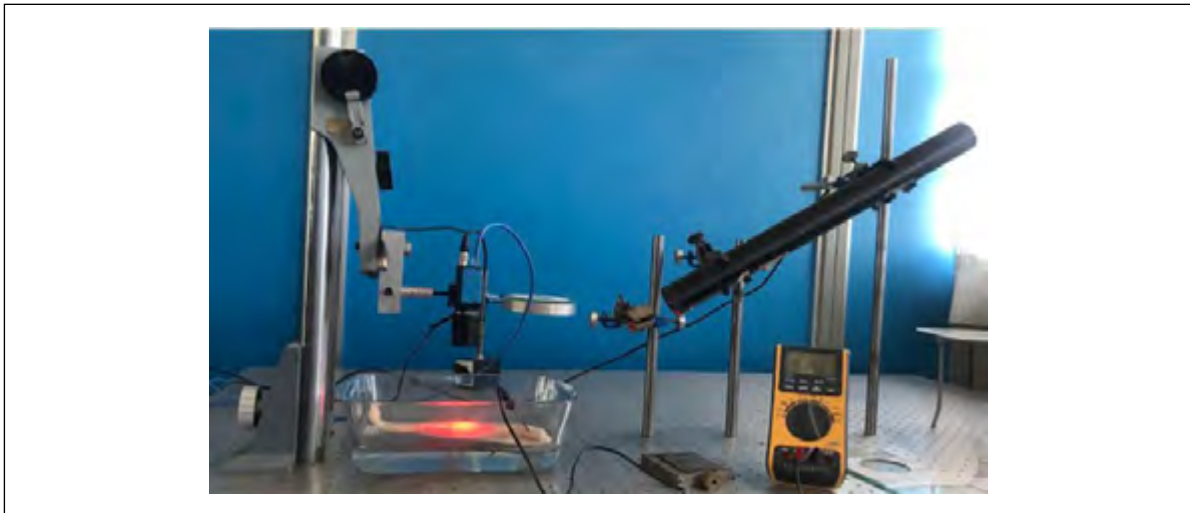
FIGURA 2. Disposición del banco de BSL para medir cambios en el filet de Macrodon ancylodon durante su tiempo de conservación en frío
