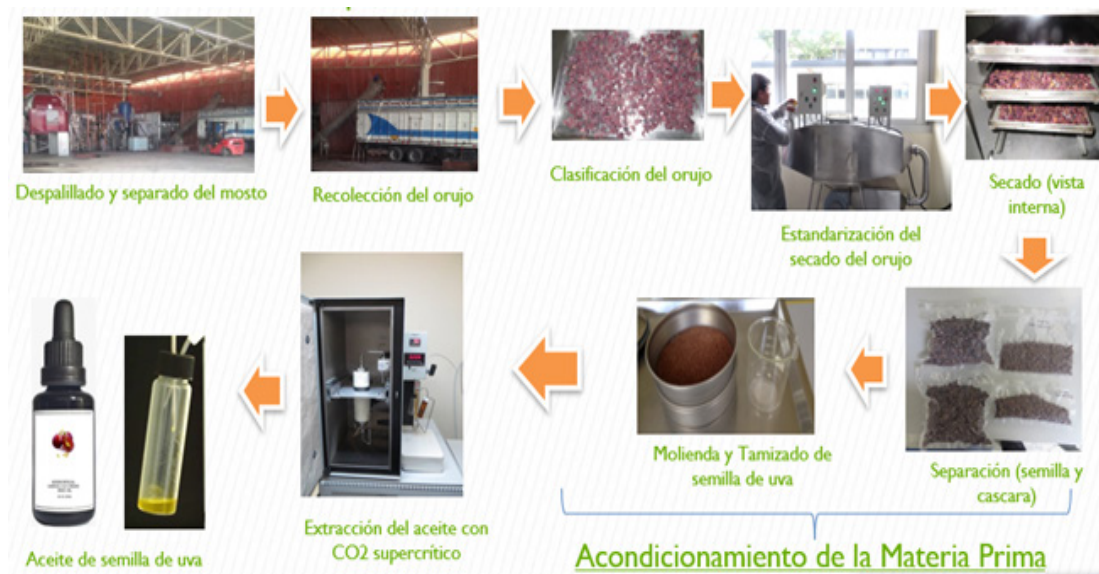
Figura 5. Proceso para la obtención de un aceite nutracéutico de semilla de uva
