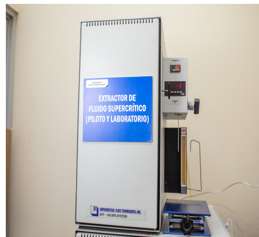
Figura 3. Parte del proceso de extracción por fluidos supercríticos del aceite de lúcuma
