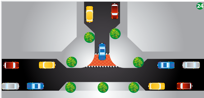
Figura 21: Alineamiento vertical inadecuado.
