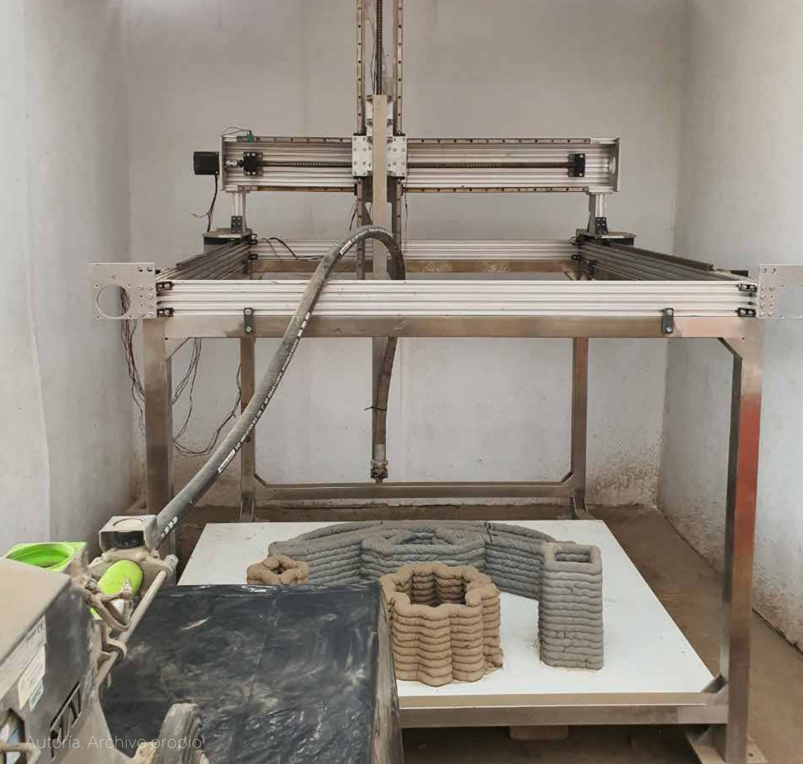
Figura 2: Prototipo de impresora 3D para edificaciones a escala natural que opera en el patio de materiales del Laboratorio de Estructuras Antisísmicas
