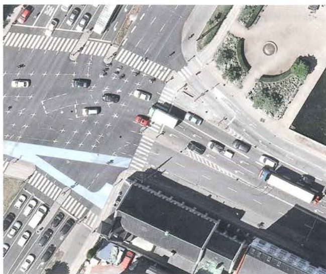
Figuras 9 y 10: «Isla de visibilidad» en Gyldenløvesgade - Nørre Søgade, Copenhague. La isla y las señales evitan el conflicto entre los autos que giran a la derecha y los ciclistas que siguen de frente (Foto: Municipalidad de Copenhague)
