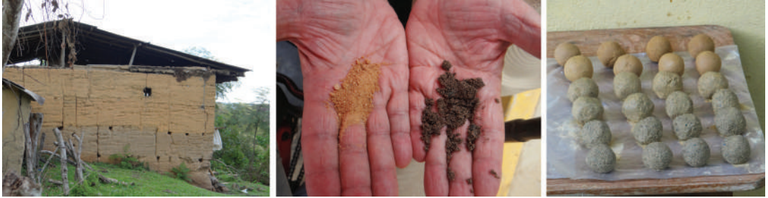
Figura 1. Izquierda: Muros construidos con greda amarilla y marrón. Centro: Arena muy fina amarilla y arena fina marrón. Derecha: Prueba de resistencia seca de greda amarilla con diferentes proporciones de arena. Fotografías: Teresa Montoya y Julio Vargas, 2015.
