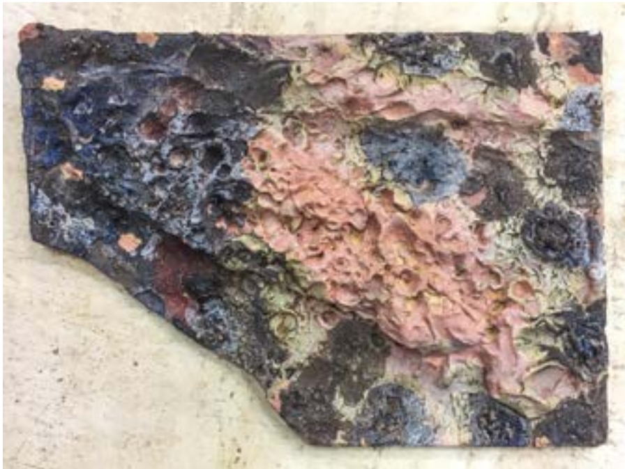
Figura 7. Óxidos metálicos activados, estables y adheridos con éxito a cemento refractario con textura en relieve.
