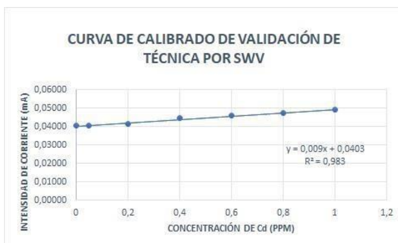
Figura 5. Correlación entre la intensidad de corriente en miliamperios obtenidos a diferentes concentraciones de cadmio en ppm.
