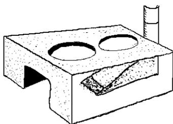
**Paso 5:** En la parte media del piso de la segunda hornilla construye un lomo de barro con la misma mezcla. Esto servirá para hacer llegar el fuego a la segunda olla y para regular la salida de humo a través de la chimenea que construirás con hojalata de latas de aceite.
