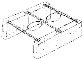
**Paso 2:** Sobre los 4 ladrillos coloca tres o más fierros o varillas de construcción que permitirán sostener las ollas.
