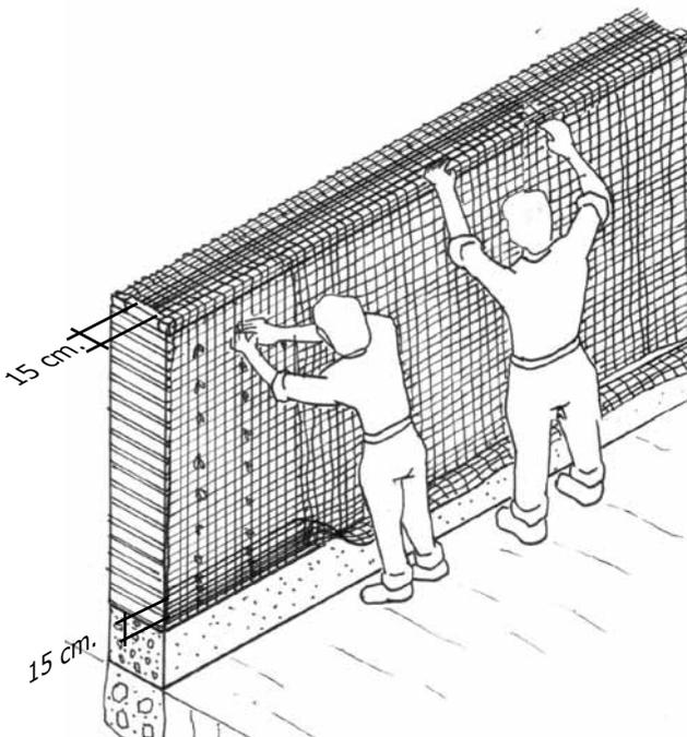
**Paso 2:** Debes fijar la malla entre dos hombres: mientras uno la sostiene estirada, el otro amarra la malla con la rafia de arriba hacia abajo y luego se empalma con la franja de anclaje, con rafia. Arriba se traslapan las mallas de los lados sobre la viga collar y se amarran con rafia y clavan a la viga.
