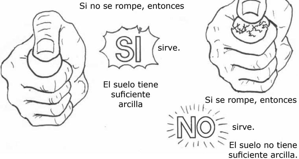
**Recuerda que** si no hay suficiente arcilla en un suelo, la mezcla de agua y suelo (barro) no será suficientemente fuerte cuando seque. Si, por el contrario, no hay suficiente gravilla o arena en el suelo, el barro se encogerá y se rajará cuando seque.
