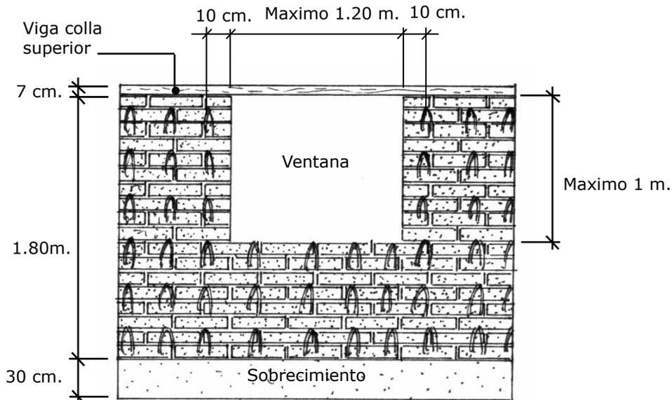
**Recuerda que** la rafia se debe colocar en la hilada inmediata inferior a la parte baja de la ventana. A los dos lados de las aberturas (puertas y ventanas) la rafia se comienza a colocar a 10 cm. de distancia.
