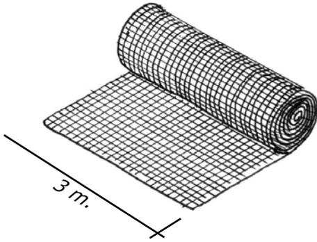
**Recuerda que** con las geomallas se envolverán todos los muros.
