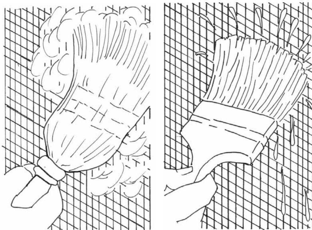
**Recuerda que** cuando el tarrajeo se raja se debilita su resistencia a la lluvia. Esto se puede solucionar agregando paja al barro. Además, antes de colocar el revestimiento, debes limpiar el polvo y dar una mano de agua a la superficie del muro.
