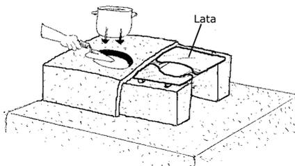
**Paso 4:** Las hornillas las formarás colocando las ollas sobre la plataforma y presionando con movimientos giratorios hasta lograr el encaje necesario.
