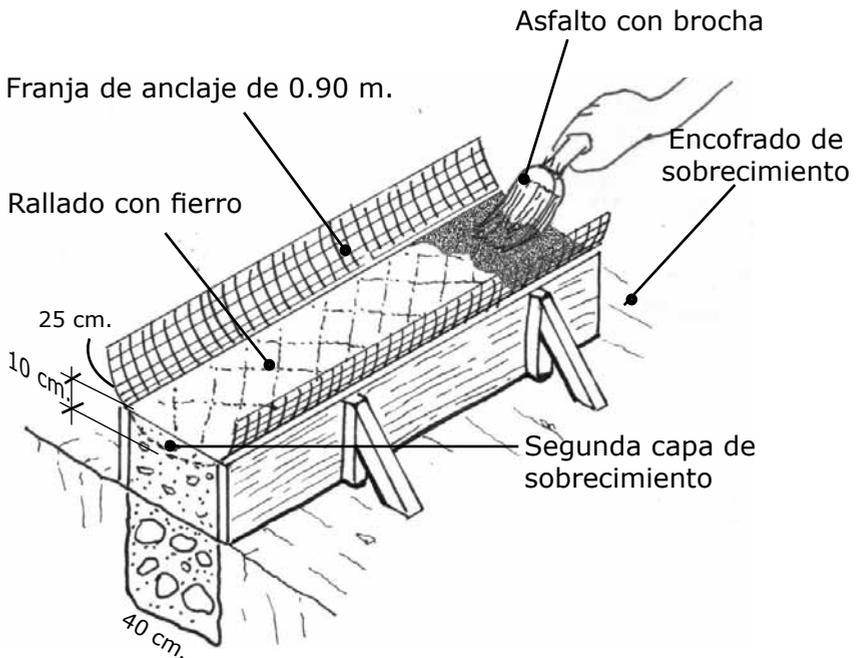
**Recuerda que** debes amarrar la franja de malla de anclaje con rafia a las mallas verticales en cada cara de los muros.
