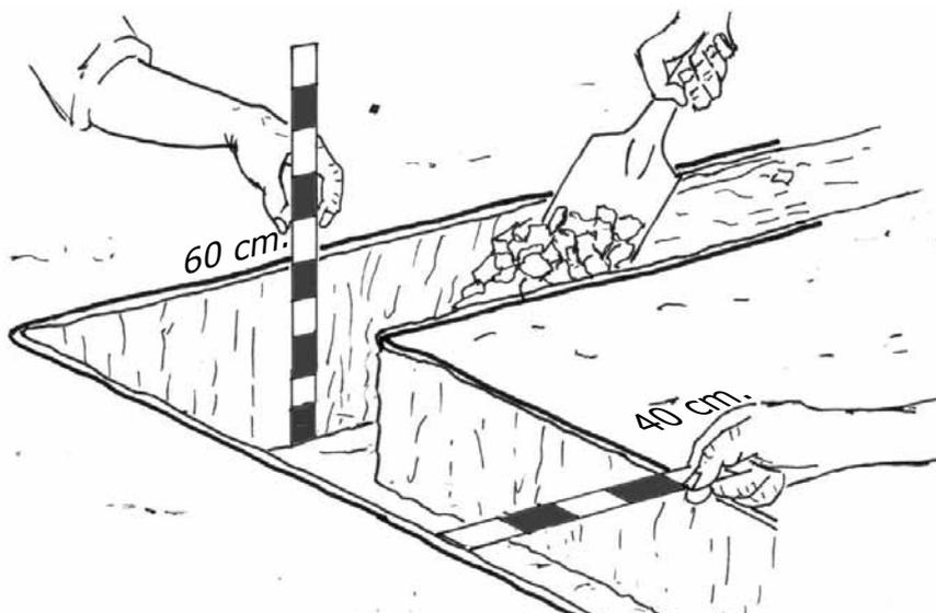
**Recuerda que** la base del cimiento debe apoyarse sobre suelo firme y no sobre suelo suelto o relleno.
