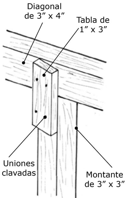
Unión de montante central con viga collar central
