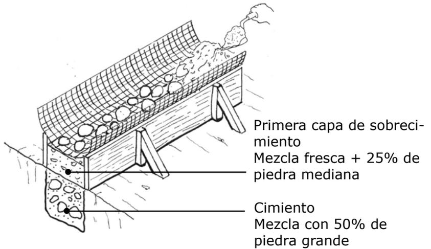
**Paso 4:** Agrega sobre las mallas la segunda capa de sobrecimiento y aplica el terminado.
