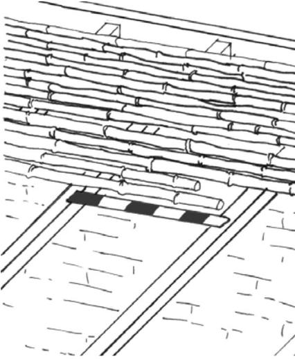
**Paso 2:** Coincidiendo con las correas, fija las cañas con cintas de triplay de 2 mm. o caña chancada, clavadas a las correas cada 20 cm.
