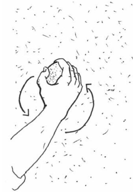
**Recuerda que** el pulido con piedra contribuye a incrementar la resistencia del tarrajeo a la lluvia pues pule el acabado de la superficie.
