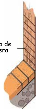
Coloca escantillones para controlar el espesor de las juntas horizontales.
