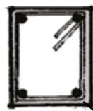
Si la luz del vano es hasta 1,5 m coloca 1 barra corrugada de 1/2" adicional al refuerzo inferior de la viga solera.
