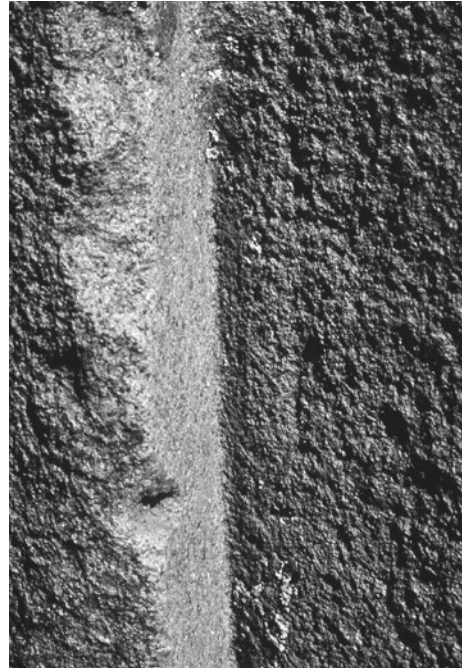
Figura 5.20. Nótese que la esquina es incluso más ajustada hacia la parte inferior. Las marcas redondas han sido reemplazadas por líneas inclinadas. Las marcas de cincel muestran la transición a una herramienta más pequeña y fácil de controlar. Nótese también que el plano a la izquierda de la esquina es suave (marcas causadas por una herramienta tipo martillo pequeña), mientras que el plano a la derecha de la esquina es más irregular (marcas de herramientas tipo martillo medianas y grandes).
