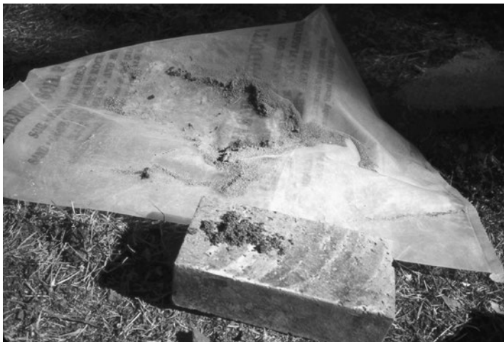
Figura 5.3. Herramienta de pulido (ladrillo de fuego) con matriz pulidora (arena que contiene silicatos).
