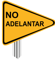
P-60 Señal: zona de no adelantar.
