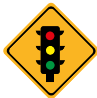
Señal P-55: proximidad de un semáforo.
