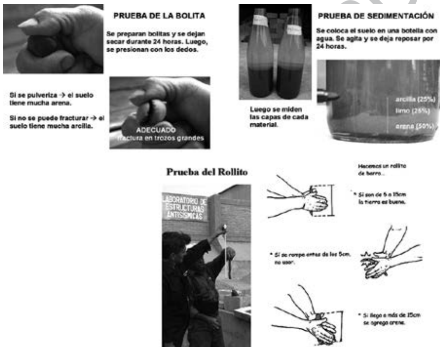
Fig. 8.12. Pruebas de campo para el reconocimiento del suelo en la fabricación de tapias o adobes.
