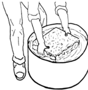
Fig. 8.20. Inmersión del adobe durante 1 segundo.
