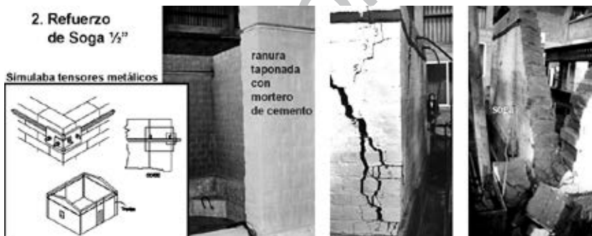
Fig. 8.37. Refuerzo de sogá.
