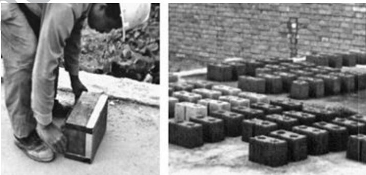
Fig. 2.26. Desmolde en tendal.
