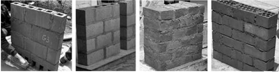
Fig. 3.3. Muretes de albañilería simple.
