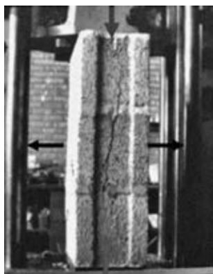
Fig. 3.12. Falla ideal de una pila.
