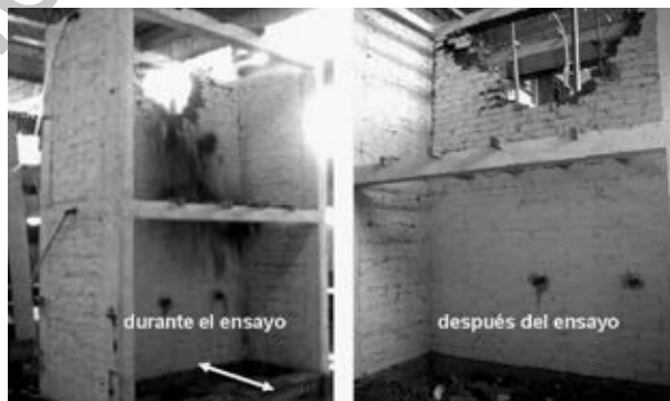
Fig. 8.62. Muros confinados de flexión y de corte en un ensayo de simulación sísmica.
