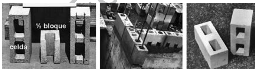
Fig. 4.60. Bloques nacionales de concreto vibrado (izq.), arcilla (centro) y sílice-cal (der.).
