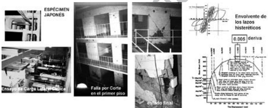
Fig. 7.29. Edificio de albañilería armada ensayado en Japón.
