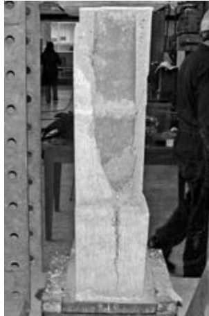
Fig. 3.17. Bloque de concreto relleno con grout.
