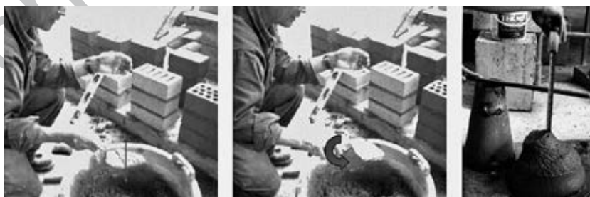
Fig. 4.27. Métodos de campo para medir la trabajabilidad de la mezcla.
