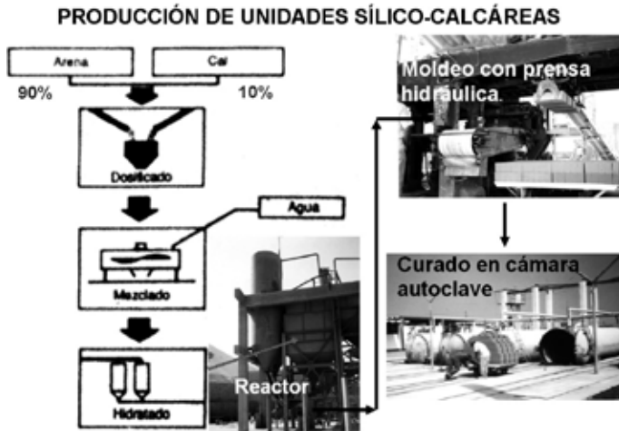
Fig. 2.35. Proceso de fabricación de las unidades sílico-calcáreas.
