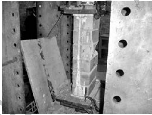
Fig. 3.15. Aplastamiento por pandeo.
