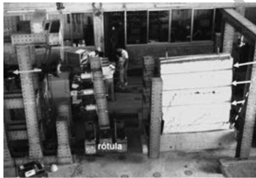
Técnica de Ensayo Estático en un Muro de Adobe o Tapial
