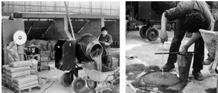
Fig. 2.61. Grout y prueba de revenimiento.
