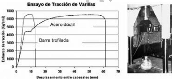
Fig. 2.65. Comportamiento a tracción del acero trefilado y dúctil.
