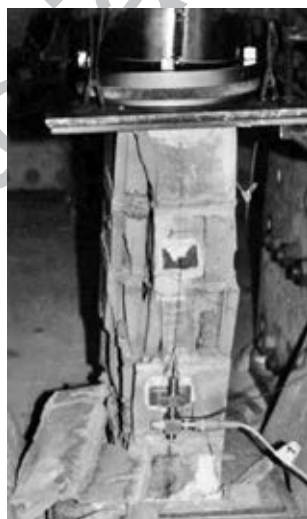
Fig. 3.13. Trituración de ladrillos huecos.
