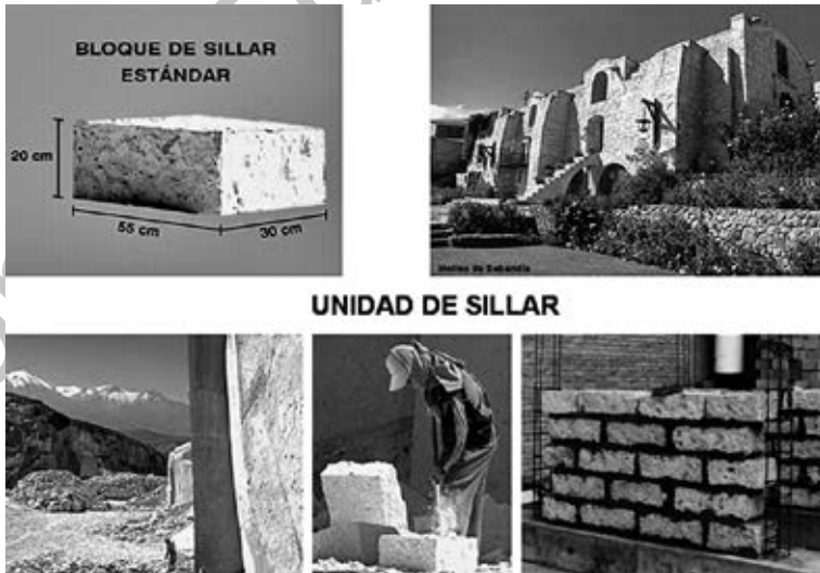
Fig. 2.38. Bloques de sillar.
