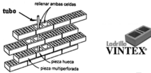
Fig. 4.40. Ladrillos mexicanos, especiales para alojar tuberías.
