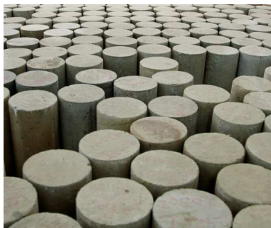
Fig.1:Probetas de concreto
