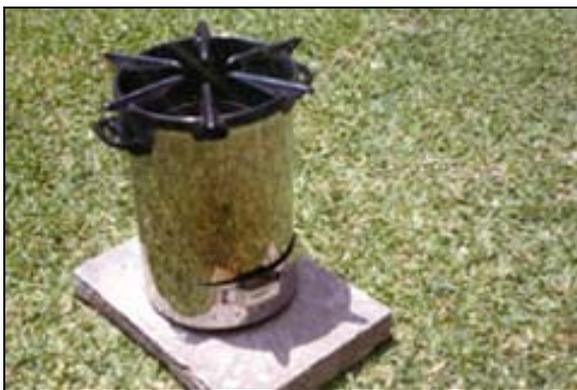
**Fig. 2** Cocina de briquetas de cascarilla de arroz Pícara.
