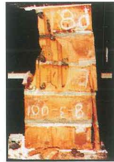
Foto 12 Pila de ladrillos de arcilla de 28 días
