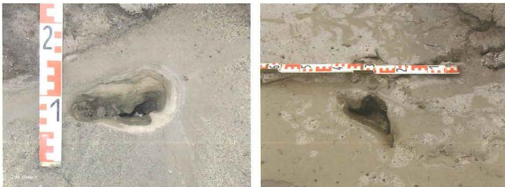
Figura 9.- Av. Defensores del Morro (Chorrillos, Lima).- Conos de eyección en la zona de la Av. Defensores del Morro (Chorrillos, Lima). Nótese los finos en la foto de la izquierda.
