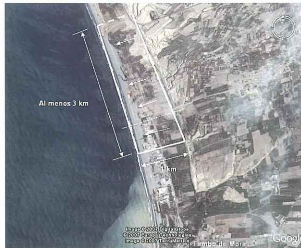
Figura 20.- Desplazamiento lateral en Canchamaná.- Medida preliminar del desplazamiento: 12 metros.
