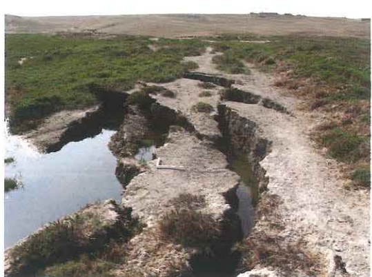
Figura 34.- Ingreso a la ciudad de Pisco.- (a) Postes inclinados al haber fallado la cimentación por licuación (los postes verticales corresponden a una instalación posterior al sismo). (b) Grietas típicas encontradas en esta zona licuada.
