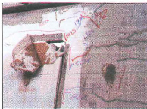
Foto 6. Detalles de la falla por trituración en las placas en las esquinas del tabique.
