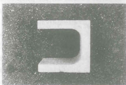
10.60. Ensayo japonés. Unidades de albañilería usadas en el ensayo. Ancho nominal 20 cm [195].
