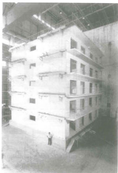
10.59. Ensayo japonés. Vista general del espécimen antes del ensayo [195].
