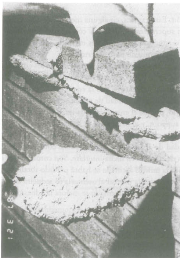
5.10. Mortero con trabajabilidad satisfactoria. Nótese consistencia, plasticidad y capacidad de adherirse a la unidad sin desprenderse.
