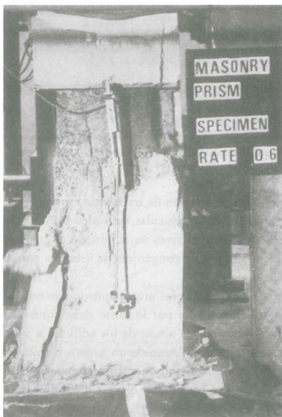
10.32. Ensayos a compresión de prismas de bloques de concreto llenos con concreto líquido.
