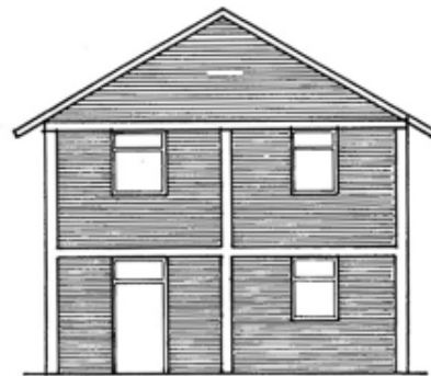
Vanos de ventanas y puertas bien ubicados
