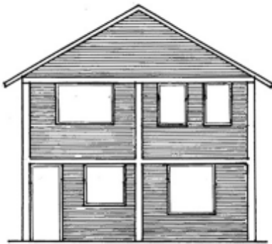
Vanos de ventanas y puertas mal ubicados
