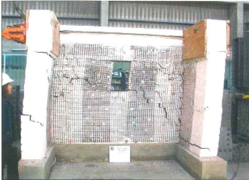
Figura 7. Ensayo de corte del muro enmallado y sin tarrajeo
