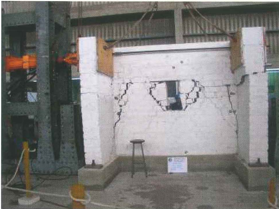
Figura 5. Muro sin refuerzo ensayado a corte cíclico
