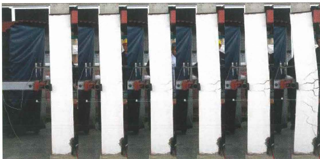
Figura 13. Secuencia del ensayo a flexión mostrando el comportamiento compatible entre geomalla y adobe.
