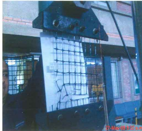
Fig. 2: Ensayo de tracción en la geomalla biaxial
