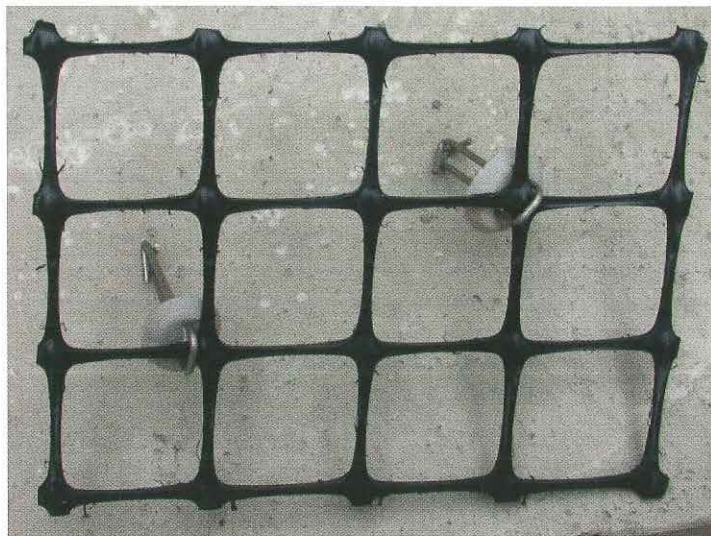
Figura 1. Geomalla biaxial de nudos rígidos.
