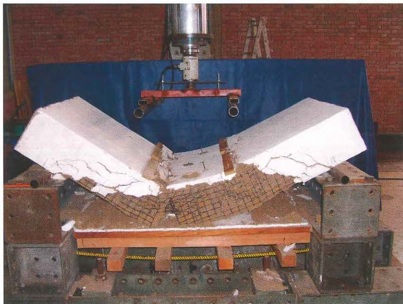
Figura 16. Falla en flexión por rotura de la geomalla en tracción.
