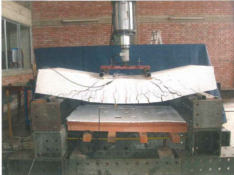
Figura 15. Ensayo a flexión de muro de adobe reforzado. La distribución de grietas corresponde a un material compuesto.
