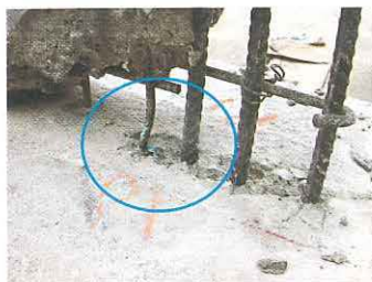
Foto 6. Inspección post-ensayo de la placa PI. Pandeo de la barra vertical extrema y cizalle de las varillas verticales de la malla electrosoldada embutida en la cimentación
