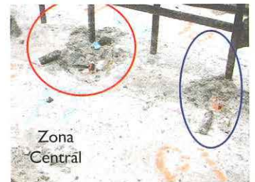
Foto 6. Inspección post-ensayo de la placa PI. Pandeo de la barra vertical extrema y cizalle de las varillas verticales de la malla electrosoldada embutida en la cimentación
