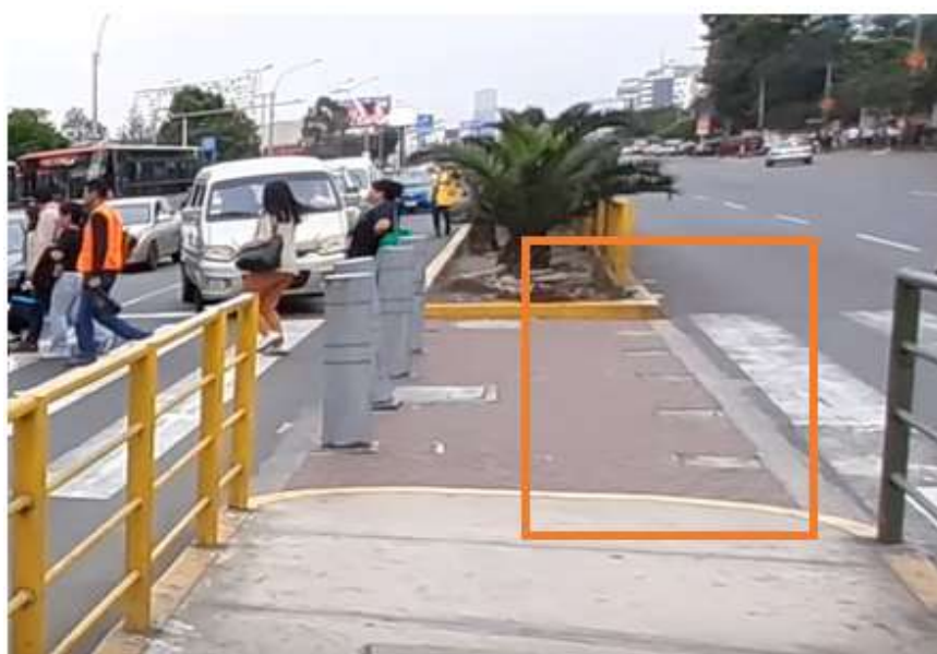
Figura 14. Ausencia de bolardos o pilotes en la Isla de Refugio 1
