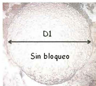
Foto 4. Prueba del O-Ring antes de levantar el cono.
