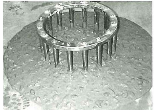
Foto 5. Prueba del O-Ring luego de levantar el cono.
