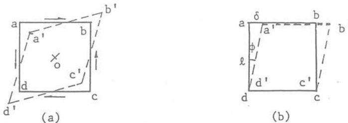
Fig.9.8-Cambio de forma de un bloque sometido a esfuerzo cortante puro. (a) El cuadrado abcd se transforma en el rombo a'b'c'd' , el centro O , de ambos, son coincidentes. (b) El rombo se ha girado, coincidiendo los lados c'd' y cd . La distorsión se mide por el ángulo \phi .
