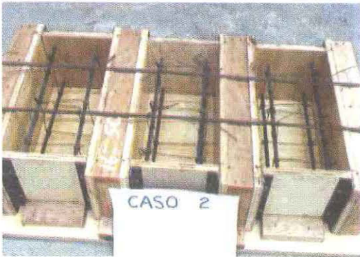
Foto 4. Molde de los especímenes
