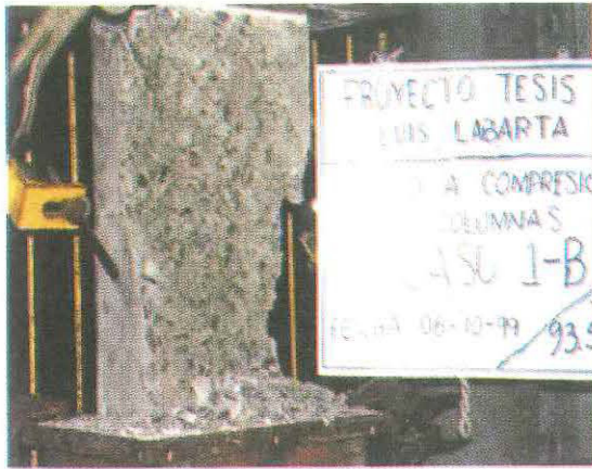
Foto 8. Estado final del espécimen no reforzado (caso 1).
