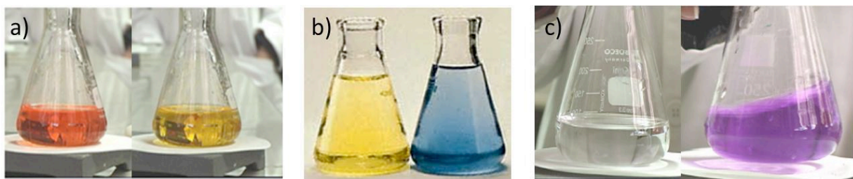
Fig. 1.- Color de viraje de indicadores en función del pH a) naranja de metilo b) azul de bromofenol y c) fenolftaleína.
