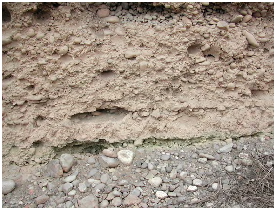
Figura 7. Foto de la estratigrafía donde se identifica las deposiciones aluviales de una calicata en el Parque de Las Leyendas, sector La Legua (Lima, Perú). Foto del arqueólogo Rafael Valdez.
