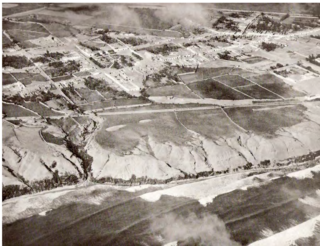
Figura 23. Foto aérea del barranco de Lima entre Chorrillos y Miraflores. Nótese las cárcavas formadas por los canales del sistema Huadca al desembocar en el acantilado. Procedencia: George Johnson. Peru from the air. With text and notes by R. R. Platt. New York: American Geographical Society, 1930.
