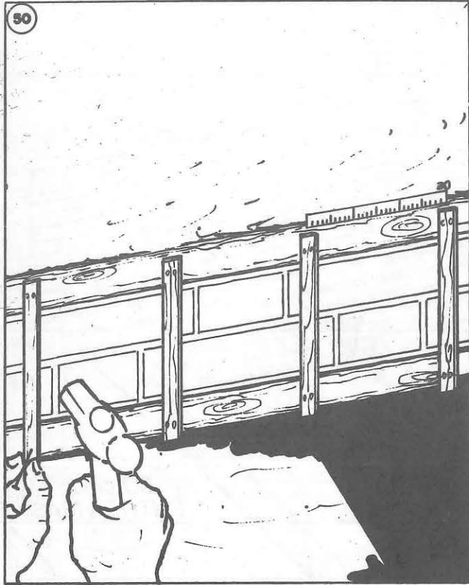
CLAVAR TIRAS DE MADERA ENTRE LOS DINTELES Y LA CADENA.
