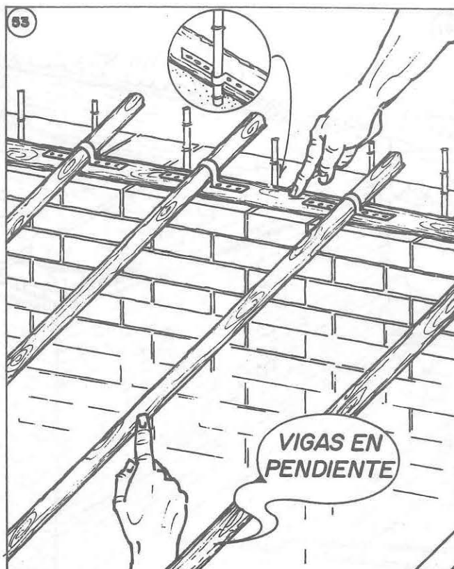
53 UNIR LAS VIGAS AL TRONCO DE LA CUMBRERA.
