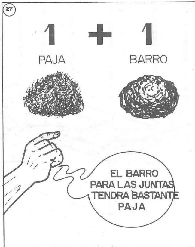
PREPARACION DEL BARRO CON PAJA PARA LAS JUNTAS.
