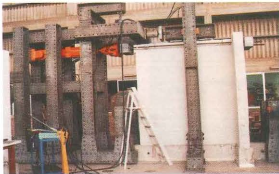
Fig.8. Ensayo de Carga Lateral Cíclica
