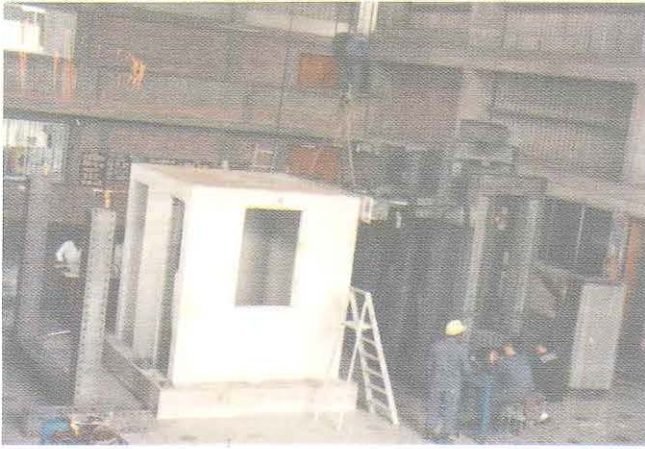
Fig. 9. Ensayo de Carga Lateral Monotónica en el Módulo
