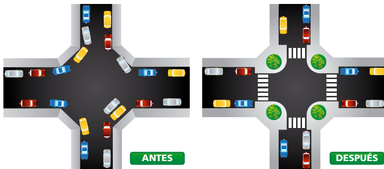
Figura 1: Ejemplo de cómo se puede reducir el radio de giro para disminuir la velocidad de los conductores y mejorar la circulación de peatones y ciclistas.
