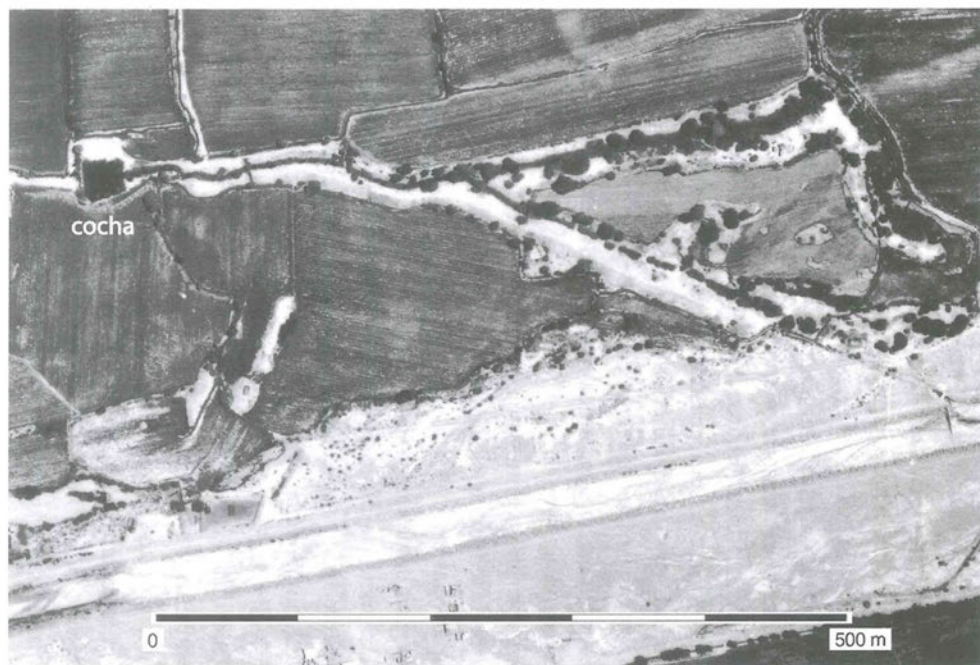
Figura 5.34. Fotografía aérea del puquio Huachuca, tomada en 1970. La cocha es visible en el extremo izquierdo. El puquio comprende dos ramales principales; el ramal sur está en realidad formado por un ramal visible en la superficie y un segundo ramal que se extiende bajo el lecho del río sin ningún rastro en la superficie. Nótese la canalización del lecho del río; también el río, que aparece y desaparece intermitentemente en la superficie al final de la temporada de lluvias en la sierra. (Foto: SAN 175-70-2439)
