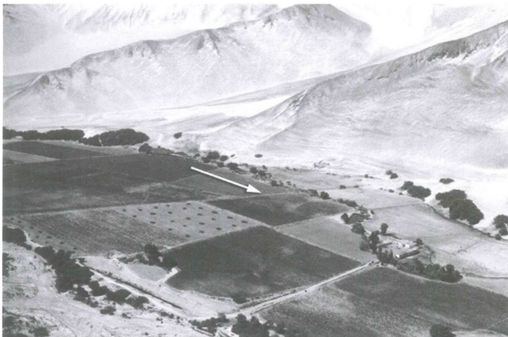
Figura 8.16. Fotografía aérea oblicua del puquio Totoral. El puquio es visible fluyendo a lo largo del flanco del valle, luego continuando dentro del valle y doblando al norte hacia su cocha. El triángulo de tierra entre el extremo bajo del puquio y el borde del valle pudo no haber estado irrigado después de la construcción del puquio. (Foto: Schreiber, 1987)
