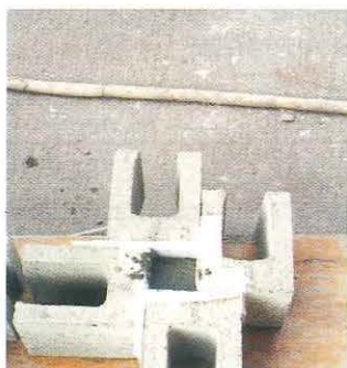
Foto 1. Moldeado del Grout
