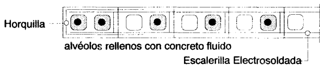
Fig. 5.35. Sección Transversal de un Muro Armado.
