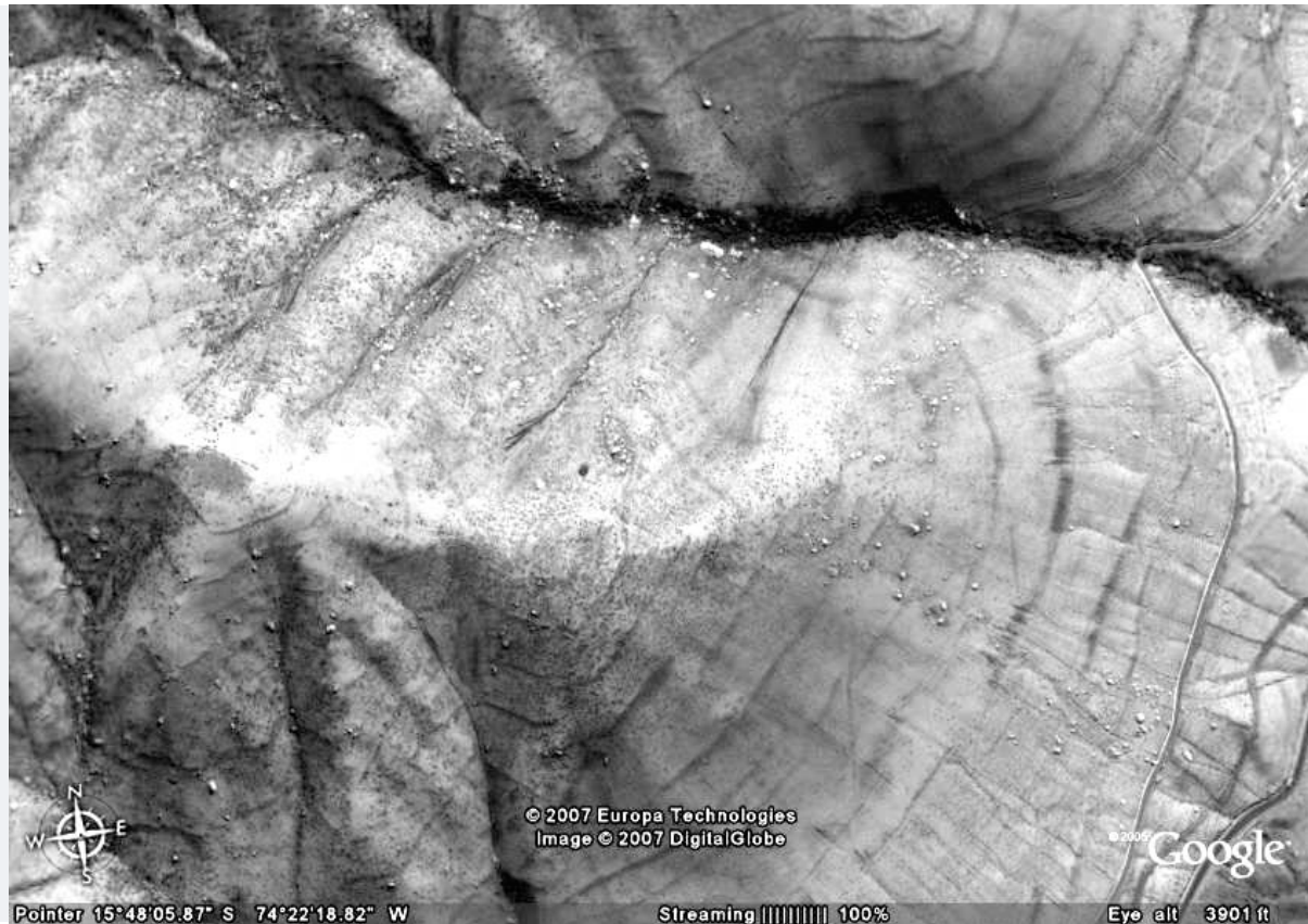
Fig. 16 Foto aérea satelital de laderas de cerros en las Lomas de Atiquipa, donde se aprecia la aparente presencia de zanjias de infiltración siguiendo las curvas de nivel (Google Earth 2007).
