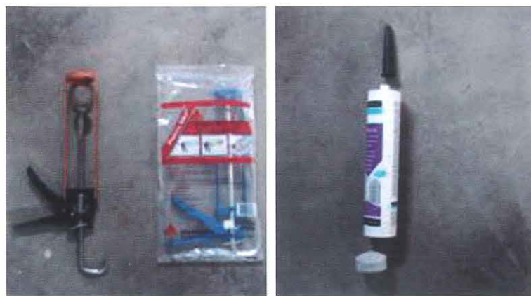
Foto 14.a) Pistola de aplicación y b) Partes de un cartucho vacío de silicona
